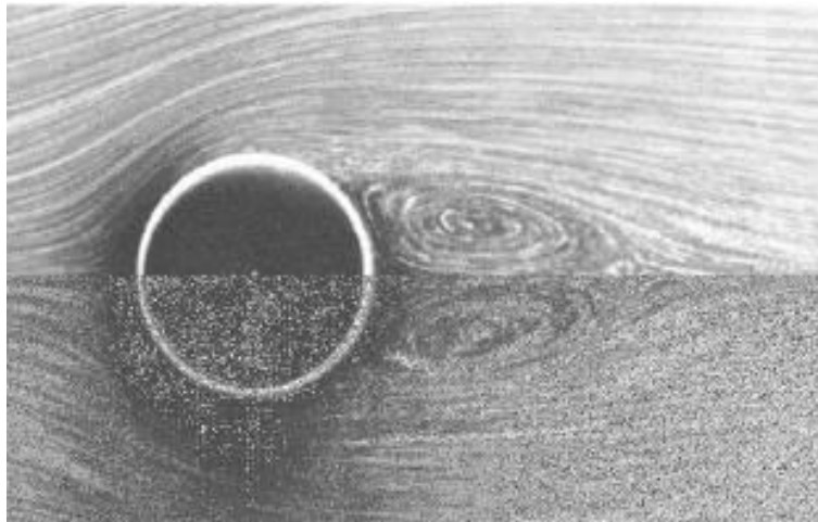
Figura 04: Escoamento laminar ao redor de um cilindro circular liso ( Re = 26 ).
